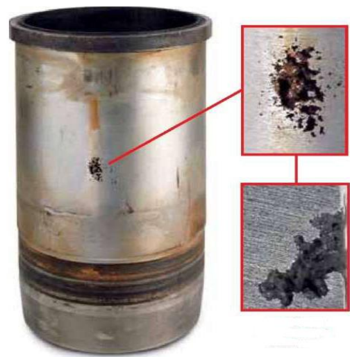
Şək. 4. Silindr oymağının xarici səthinin yaralı korroziyası
