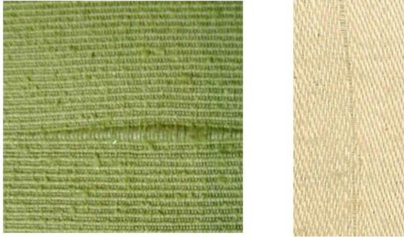
Şəkil 2. Parçanın xarici görünüş qüsurları
